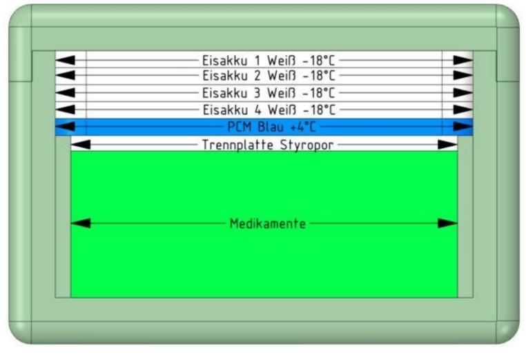
Beginnen Sie den Bestückungsvorgang von unten nach oben, beginnend mit der Ware. Anschließend die Trennplatte einlegen und das blaue PCM Kühlakku auflegen. Abschließend jetzt noch die durchgefrorenen Eis Akkus einbringen. Die Box mit dem Styropordeckel schließen und diese abschließend in die Tasche einsetzten
